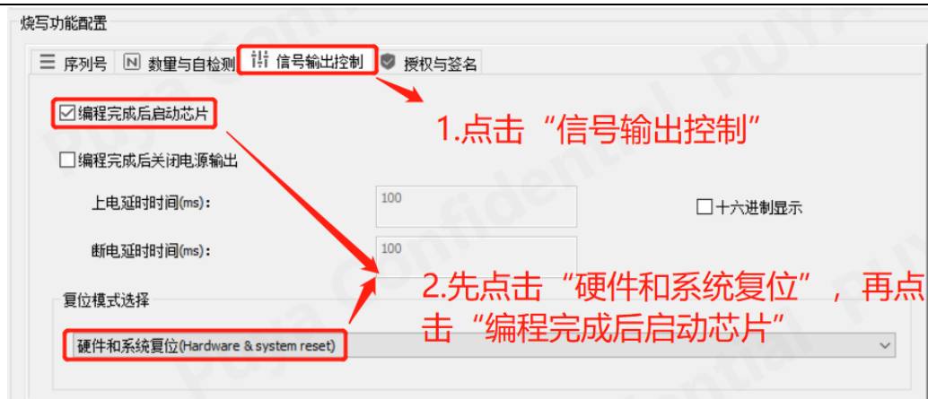
图 14-3 创芯工坊操作勾选“编程后重启芯片”
